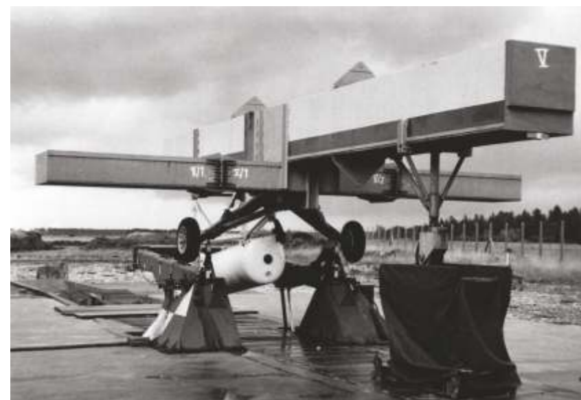
Una delle "iron crosses" utilizzate per simulare il comportamento dell'aeroplano durante il decollo.
