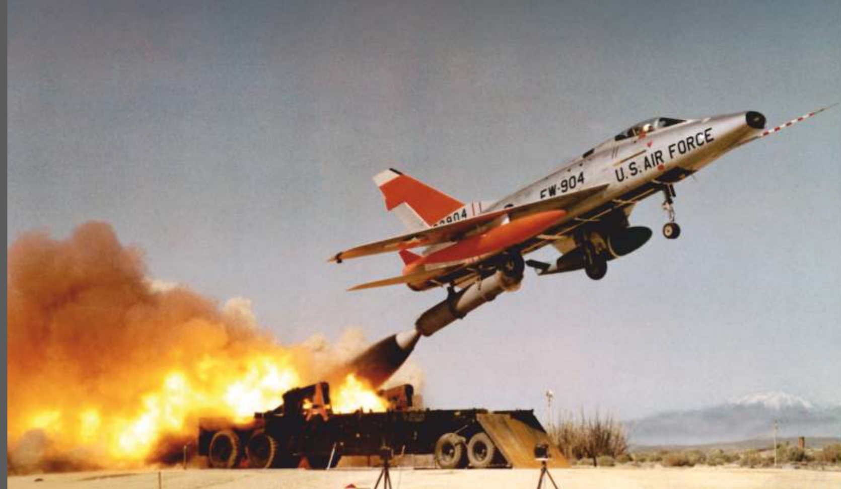
Sulla Edwards AFB il sistema ZELL viene testato su un North American F-100 Super Sabre configurato per un ipotetica rappresaglia nucleare. L'aeroplano trasporta infatti sotto l'ala sinistra il simulacro di una bomba atomica Mk. 7.
