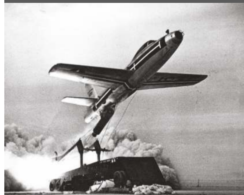
3 Un Republic F-84 Thunderjet viene lanciato dalla rampa durante i test del sistema ZELL negli Stati Uniti.
