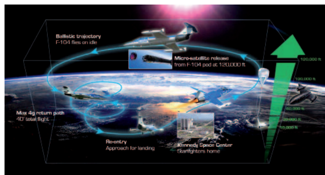
Il profilo di una missione suborbitale per il lancio di nanosatelliti
